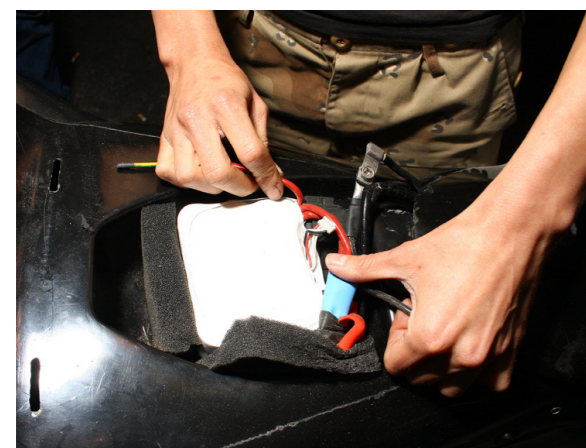
Auf der Piste (ohne Lichtmaschine) reicht die Spannung des 890 Gramm wiegenden 6,9 Ah-LiFePos locker für zwei 20 Minuten-Turns
