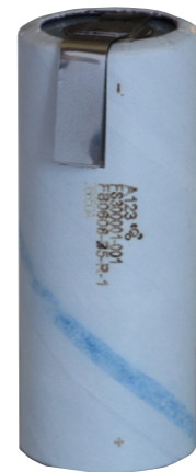
Vier solcher 3,3-Volt-Einzelzellen sind nötig, um einen Akkupack fürs Motorrad zu konfektionieren. Tiefentladung mögen sie nicht
