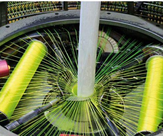
Im Webstuhl wird der Manchon mit textilem Gewebe umspannt
