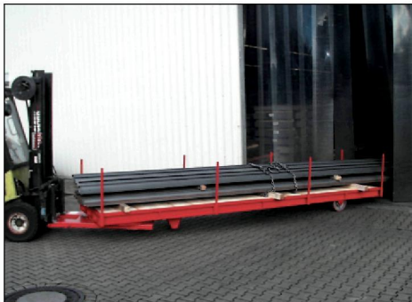
Transport von Langgütern; kleiner Wendekreis durch Direktaufnahme
