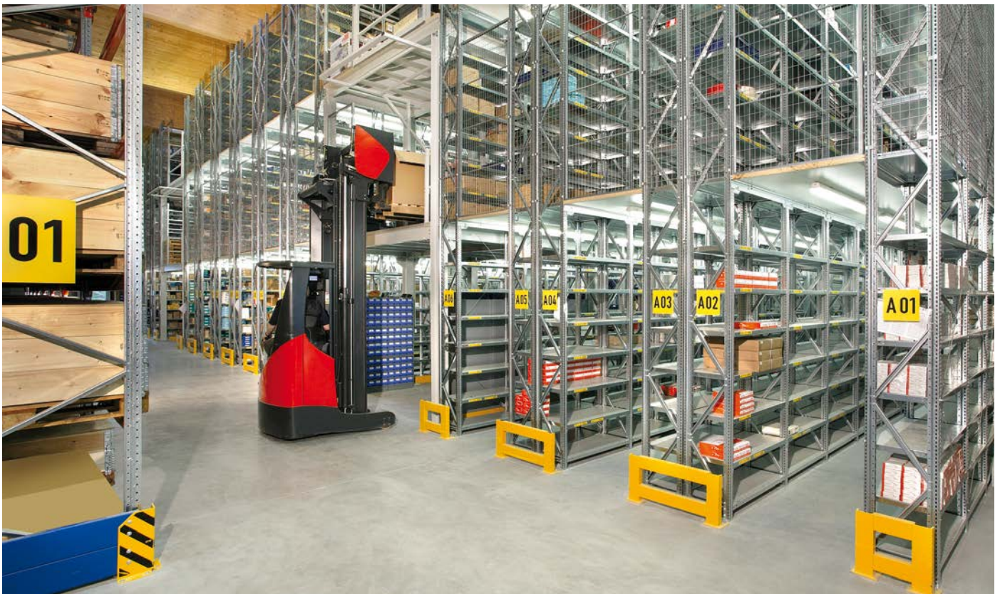
Das Lager mit einer Grundfläche von 900 Quadratmetern ist nahezu quadratisch aufgeteilt. Das manuelle Kommissionierlager verfügt über eine 3-geschossige META HIGH-CLIP Fachbodengeschossanlage.
