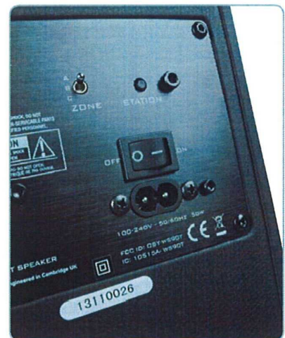
Per Kippschalter stellt man die gewünschte Hörzone ein. Bis zu drei sind möglich
