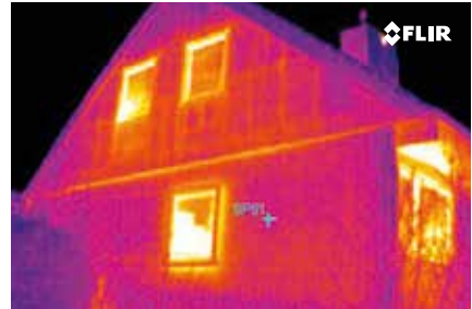
Dieses Wärmebild zeigt ein Beispiel für eine mangelhafte Dämmung in einem Wohnhaus und findet bei Rockwool Thermografiekursen Verwendung.
