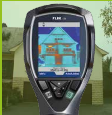
FLIR i3, Temperatur an 3600 Punkten
