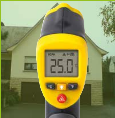
IR-Thermometer, Temperaturmessung an einem Punkt
