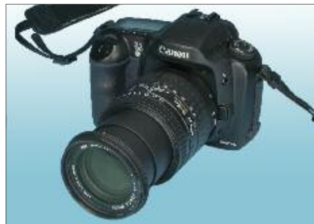
Abb. 1.12 Digitale Spiegelreflexkameras mit optischem Sucher ermöglichen die exaktere visuelle Scharfeinstellung durch den manuellen Fokus.
