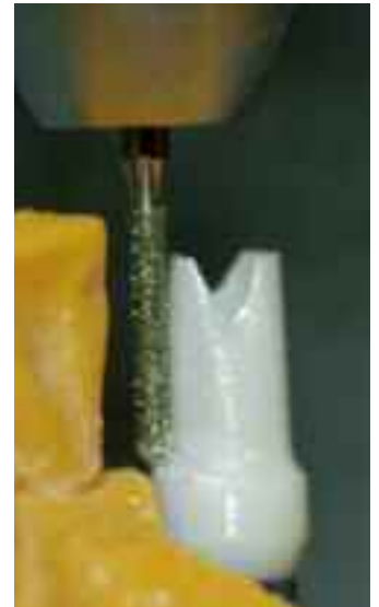
Abb. 18 Beschleifen des Zirkonabutments unter Wasserkühlung mit Zirkondiamant ZR 6881.314.016
