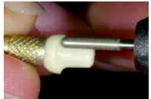
Abb. 20 Feinschliff mit Zirkondiamant ZR 6881.314.012
