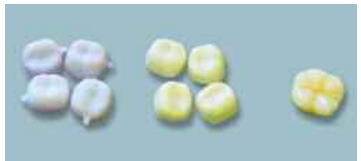
Abb. 2 Geschliffenes Glaskeramik-Gerüst vor dem Kristallisationsbrand (links), nach dem Kristallisationsbrand (Mitte) und mit e.max Ceram verblendet (rechts)
