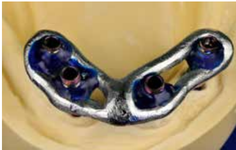
Abb. 1.37 Eine Brezel aus Metall ist eine präzise Kontrollmöglichkeit
