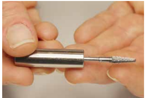
Abb. 5.33: Die exakte Rundlaufgenauigkeit rotierender Instrumente kann mit einer speziellen Fräserprüflehre festgestellt werden. Nur wenn sich der Schaft des Fräasers ohne Widerstand in die Prüflehre schieben lässt, hat er keine Unwucht.
