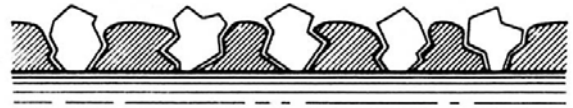
Abb. 5.42: Industriediamanten in einem Diamantschleifer: Die besonders langlebige galvanische Bindung umschließt einen Großteil der Kristalle.
