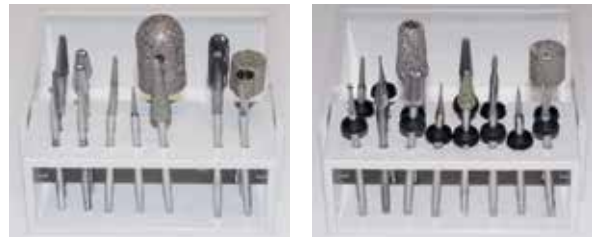
Abb. 5.10 und 5.11: Zwei individuell zusammengestellte Fräsersortimente, die beide im Routinebetrieb kaum Wünsche offen lassen. Trotzdem unterscheiden sie sich. Der rechte Fräsersatz ist mit Schutzkappen bestückt, die bei Nutzung von Nasstechnik das Eindringen von Flüssigkeit in das Handstück verhindern.
