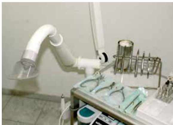
Abb. 5.26: Punktabsaugung. Der Staubsauger schaltet sich automatisch ein, sobald der Absaugarm in das Arbeitsfeld gezogen wird. Die Saugkraft ist bei dieser Konstruktion nur direkt am Staubsauger regulierbar.
