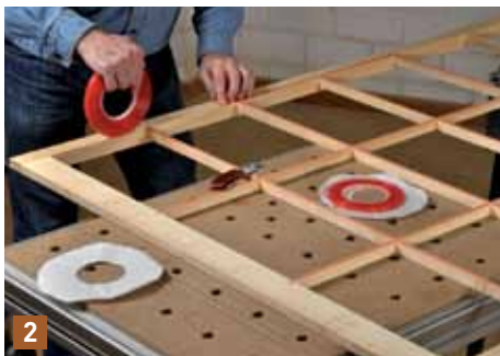
2 Bekleben Sie zuerst nur die vier Sprossenfelder, die Sie mit einem Papierabschnitt abdecken können. Entfernen Sie noch nicht die Schutzschicht vom Klebeband!
