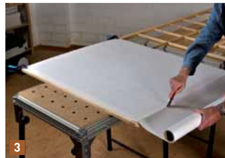
3 Rollen Sie das Papier quer über die vier Felder aus und schneiden Sie es mit einem scharfen Cuttermesser am Rahmenende ab. Richten Sie es dann genau an der unteren Sprosse aus ...
