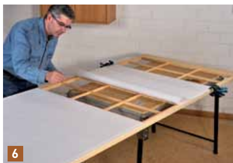
6 Anschließend wieder die nächsten vier Sprossenfelder mit Klebeband versehen, Papierlage zuschneiden und genau über der zuletzt beklebten Quersprosse ausrichten und mit Federzwingen fixieren. Papierlage zurückschlagen und zunächst nur das Klebeband von dieser Quersprosse entfernen.
