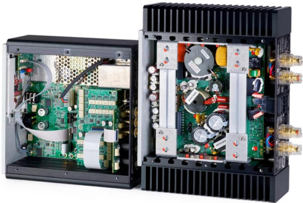
Die kompakten Abmessungen der Benchmarks erfordern vor allem beim Verstärker (rechts) Grips und die taktisch kluge Platzierung aller Baugruppen. Denn wie unschwer zu erkennen ist, besteht der AHB praktisch nur aus Netzteil.
