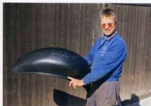
Für Youngtimer und moderne Autos werden die Innenkotflügel aus Kunststoff gefertigt.
