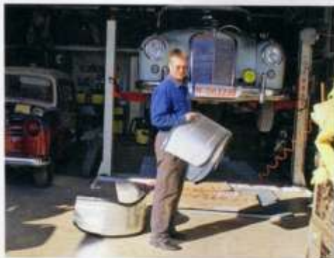
Für Fahrzeuge bis etwa Baujahr 1980 werden Aluminium-Innenkotflügel angeboten.
