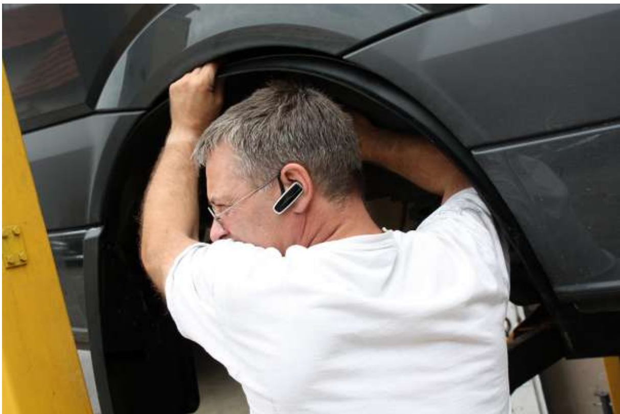
Einsetzen der Innenkotflügel
