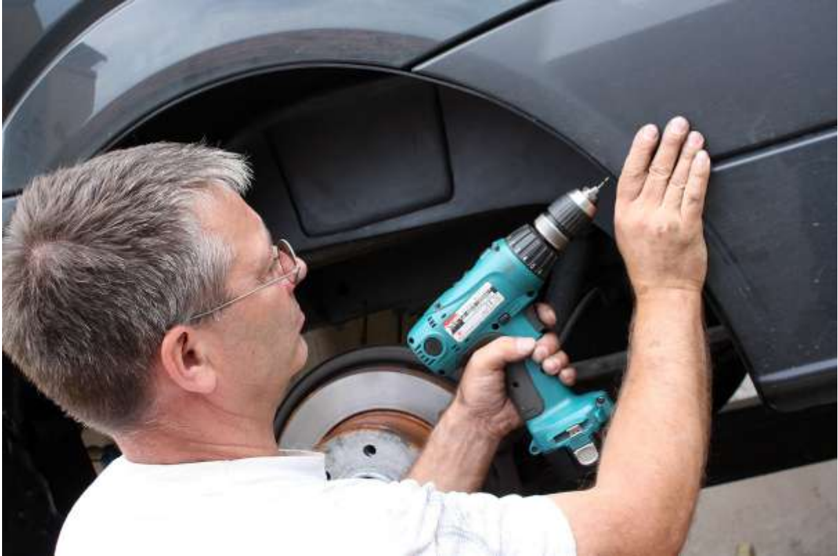
Bohren der Schraubenlöcher (siehe Bohransatz-Vertiefungen im Kunststoff)
