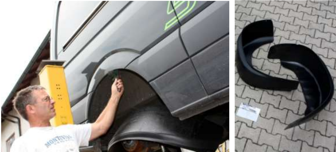
Reinigung der Radkästen vor der Montage / LOKARI-Innenkotflügel
