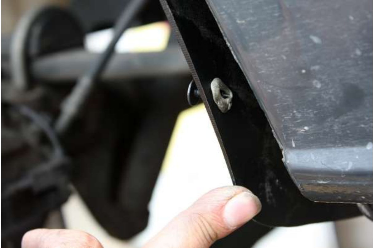
Formen von Dichtmassen-Ringen um die Schrauben
