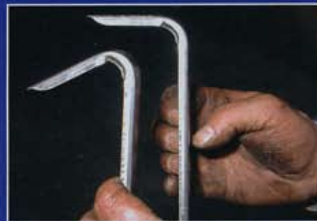
Die beiliegenden Montagewinkel aus Aluminium lassen sich problemlos von Hand biegen
