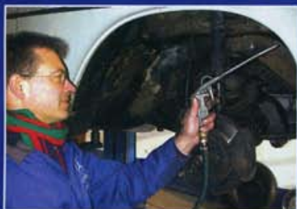
Druckluft hilft beim Trockenlegen des Radhauses, damit das Rostschutzwachs später besser hält
