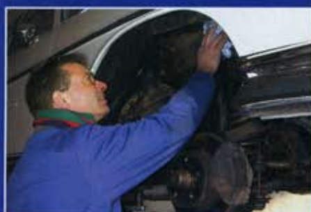
Auf der Bühne sucht er dann nach Schäden, die vor dem Einbau der Lokaris beseitigt werden müssen
