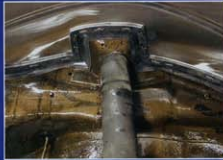
...dort ganz von allein stecken. Eigenarten der Karosserie, wie hier die Stoßdämpferaufnahme...
