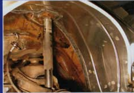
Blick nach vorn: Der empfindliche Lampentopf ist für Steine und Schmutz nicht mehr erreichbar
