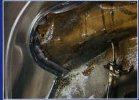
...oder Wölbungen wie diese wurden bereits ab Werk berücksichtigt und ausgespart
