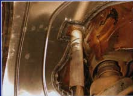
Über dem Schwenkbereich der Vorderräder liegt nun das stabile 1,5-Millimeter-Aluminiumblech
