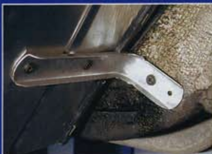
...sie vor dem Eindrehen großzügig mit einem Rostschutzmittel behandelt werden
