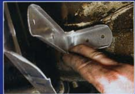
So findet sich schnell die richtige Position für den Haltewinkel. Unten im Bild der kleine „Spoiler“
