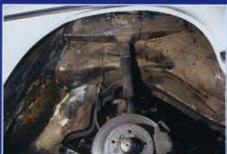
Bis auf wenige Steinschlagspuren zeigt sich der Sternenkreuzer in diesem Bereich kerngesund
