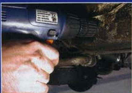
Auch vorn lässt es sich nicht vermeiden, ein Loch in die Quertraverse zu bohren
