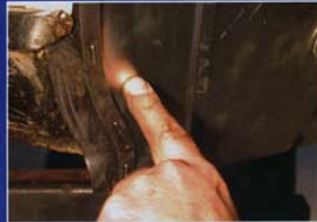
Wenn das Schwellerende stabil genug ist, kann die Verschraubung hier auch direkt erfolgen
