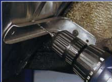
Ohne anzuzeichnen bohrt Thomas Hanna dann zwei Löcher in den Innenkotflügel
