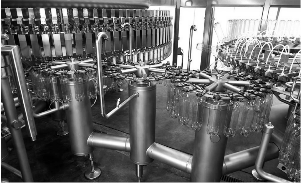
Abbildung 292 Bauweise einer FFM ohne separaten Vortisch (Monotec nach Krones)
