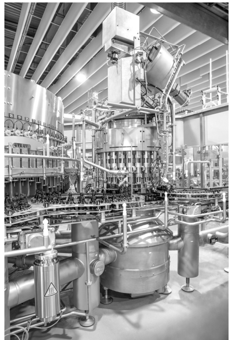
Abbildung 292a Füll- und Verschließmaschine Innofill Glass DRS mit separaten Antrieben (nach KHS)
