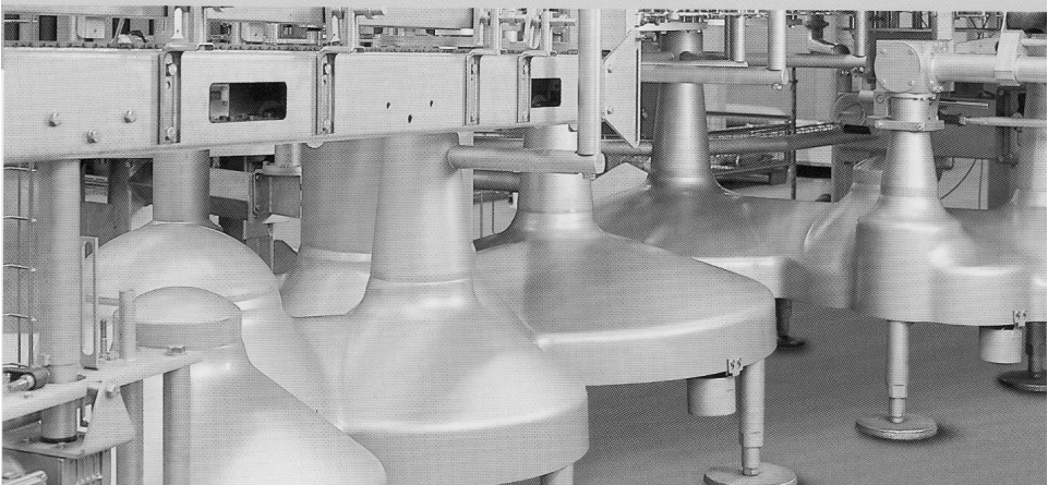
Abbildung 291b Gestaltungsvarianten für moderne Vortische (nach KHS)
