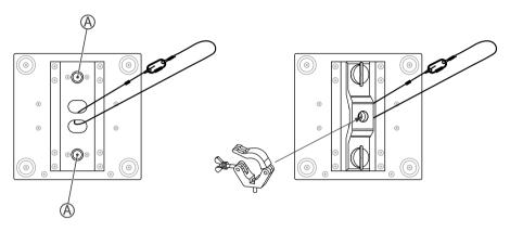
Die Gewinde an der Gehäuseunterseite (A) dienen zur sicheren Montage des mitgelieferten Haltebügels. Daran können Flugadapter (Half Coupler, Trigger Clamps, C-Haken u.ä.) befestigt werden. Das Sicherheitsfangseil wird durch die Aussparungen an der Gehäuseunterseite geführt.
