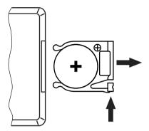
Drücken Sie die Sperre des Batteriehalters zur Gehäusemitte und ziehen Sie den Batteriehalter wie eine Schublade heraus. Legen Sie die Batterie ein. Die Batterie liegt richtig, wenn der Pluspol zum Gehäuseboden der Fernbedienung zeigt. Schieben Sie den Batteriehalter zurück in die Fernbedienung, bis er einrastet.
