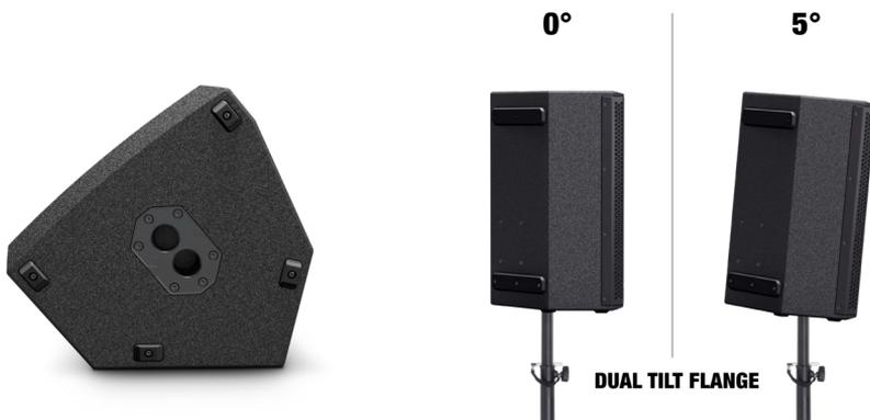
Głośniki wykorzystują kołnierz statywu z mocowaniem statywu o kącie 0° (umiejscowienie z tyłu) i mocowanie statywu o kącie nachylenia 5° (umiejscowienie z przodu). Przykłady zastosowań: Mocowanie statywu o kącie 0° należy stosować do nagłośnienia w przypadku stojącej publiczności, natomiast mocowanie statywu o kącie nachylenia 5° – w przypadku siedzącej publiczności.
