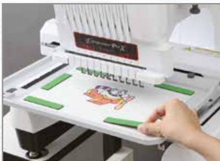
Mit den Magneten befestigen.
