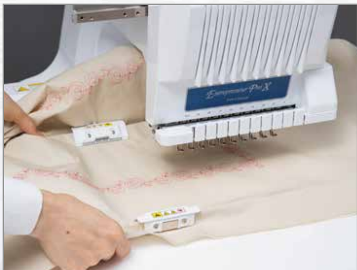
Einfaches Verbinden von Mustern durch Verschieben des Materials
