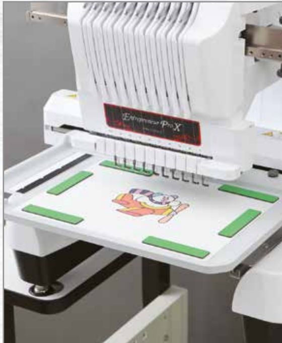
Das eingelegte Bild mit der integrierten Kamera einscannen.
