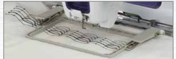
Die PR bietet einen Stickbereich von 300 x 100 mm. Die VR bietet einen Stickbereich von 180 x 100 mm.
