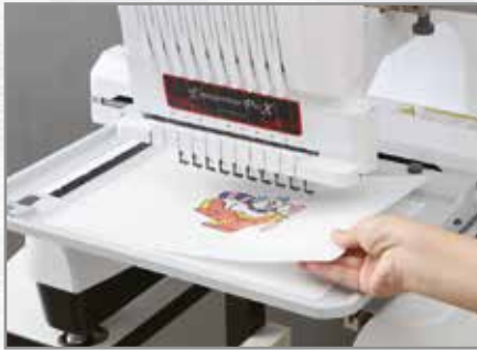
Gedrucktes bzw. gezeichnetes Bild auf den Rahmen legen.
