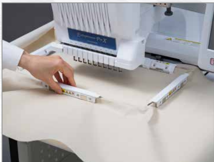
Einfaches Einspannen durch Einzelmagnete
