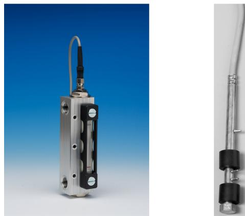
Die im Führungsrohr eingesetzten Reedkontakte haben einen Abstand von 35 oder 40 mm (bitte bei Bestellung angeben), damit ist der Abstand zwischen Ölnachfüllung und Ölminimum festgelegt. Eine gemeinsame Verstellung ist mittels Klemmverschraubung möglich.
