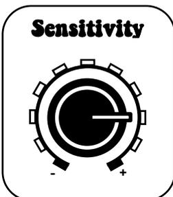
Der Sensitivity-Regler beeinflusst die Empfindlichkeit der Pitch-Antenne. Am rechten Anschlag ist die Empfindlichkeit der Antenne am größten. Der spielbare Gesamtbereich wird dadurch praktisch gestreckt. Und die Antenne reagiert bereits auf weiter entfernte Handbewegungen.
