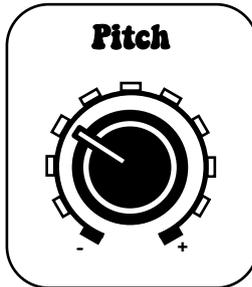
Das Theremin verfügt über einen Pitch-Regler auf der Oberseite des Gerätes und einen Pitch-Einstellregler auf der Unterseite des Gerätes. Beide Pitch-Regler haben dieselbe Funktion, wobei der Regler auf der Frontseite des Gerätes eine Feineinstellung ermöglicht.
