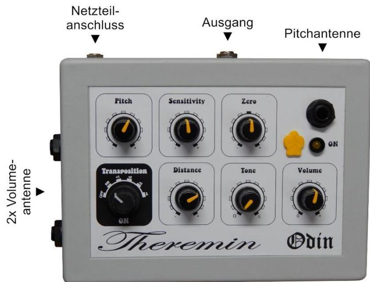
Das Theremin wird durch die Annäherung und Entfernung der Hand des Spielers gespielt. Hierbei gilt: Je weiter die Hand von der Antenne entfernt wird, um so tiefer wird der Ton.
