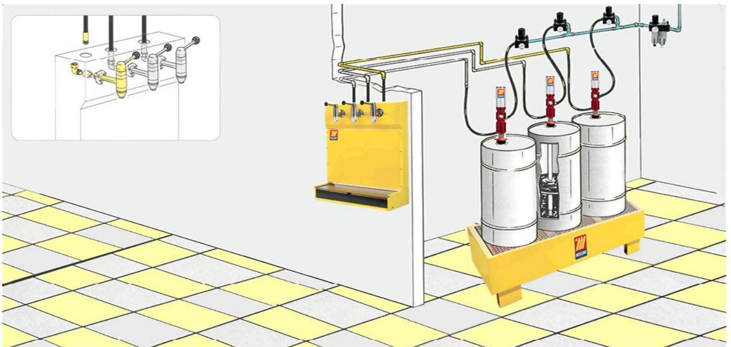
Diese Lösung ist für das manuelle Zapfen von Öl am Arbeitsplatz gedacht. Aufgefüllt werden Meßbecher, Eimer oder Ölkannen um weiter der manuellen Anwendung zu dienen. Die Gefäße ruhen beim Auffüllen auf einem Gitterrost welches überlaufendes Öl in einer darunterliegende Auffangwanne sammelt. So bleibt der Arbeitsbereich sauber.
