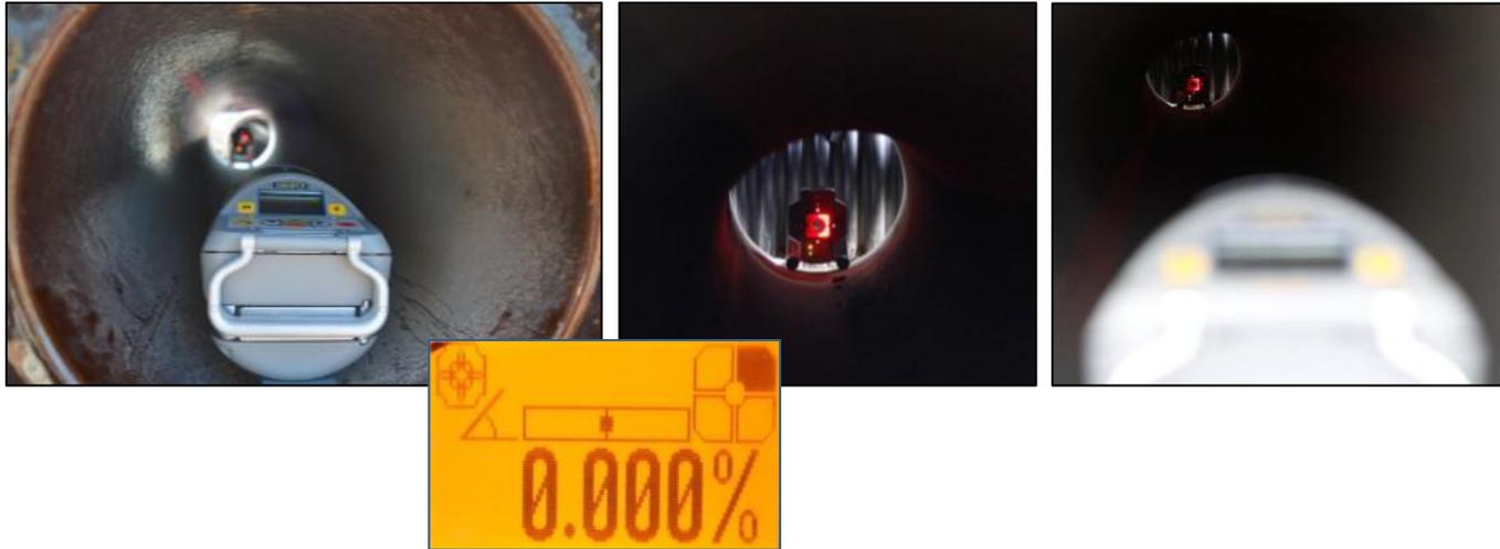
Alle LEDs An bestätigen, Neigung messen ist fertig; der Strahl geht durch's Loch im SF; das Display zeigt die gemessene Neigung
