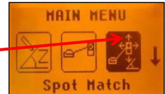
Kurzes Drücken der **E** Taste startet das automatische Neigung messen. Der Fanbeam wird automatisch auf die Mitte des SF803 ausgerichtet.
