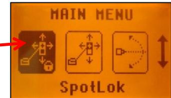
Kurzes Drücken der **E** Taste startet die automatische SpotLok - Funktion. Der Fanbeam wird automatisch auf die Mitte des SF803 ausgerichtet.
