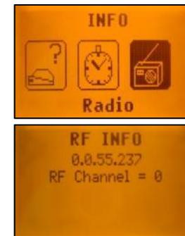
Kurzes Drücken der **E** Taste zeigt die Informationen zum **Laser (Seriennummer, Softwareversion, interne Temperatur), Gesamtlaufzeit (endloser Zähler) oder Funk (aktueller Funkkanal)** an.
