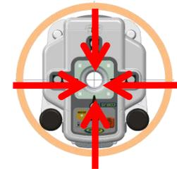
SpotLok ausgerichtet: → LEDs An für 5 Minuten, Danach blinken sie alle 5 Sek. → SpotLok ist noch OK.
