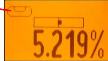
Falls der Laser außerhalb des Nivellierbereichs von  $-12\%$  bis  $+40\%$  aufgestellt ist, blinkt der Laserstrahl
